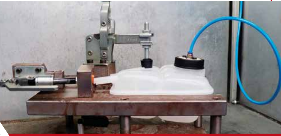
БАР ТЕСТ - тестирање на притисокот на воздухот и водата
