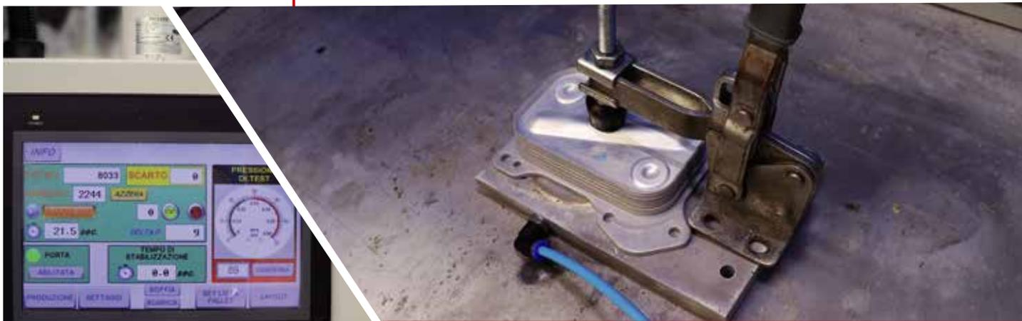
Épreuve de pression à l'air avec une pression maximale de 8 bars.
