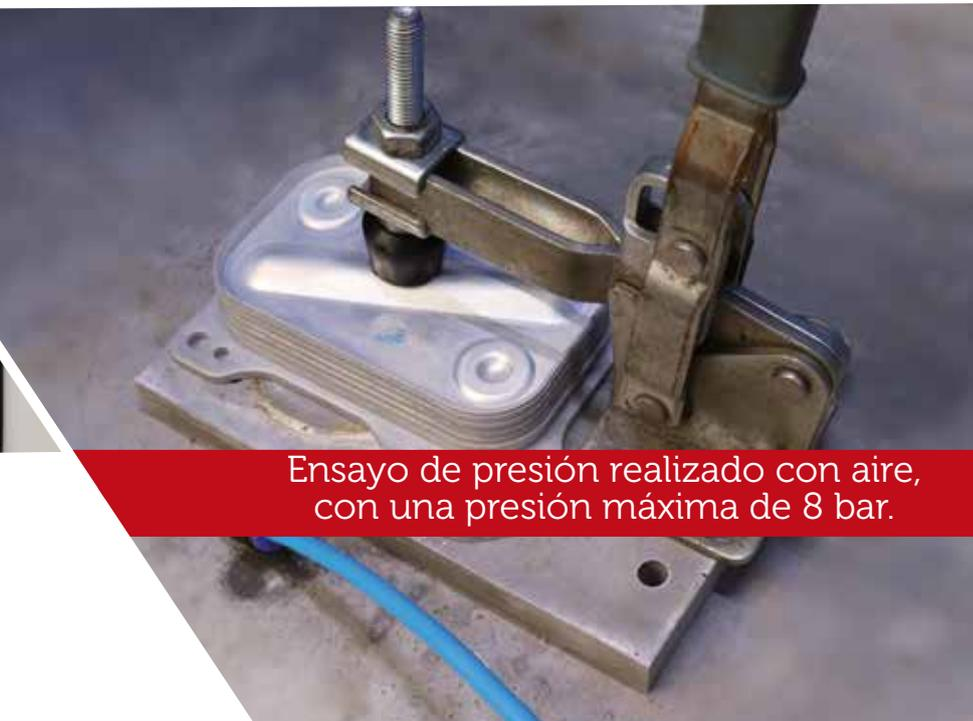
Ensayo de presión realizado con aire, con una presión máxima de 8 bar.
